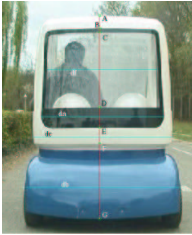
FIG. 3.1 – Position des points de mesure du CyCab et de distances.
